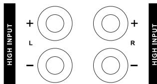
*Se l'amplificatore è dotato solo di uscite per i diffusori, collegate i morsetti **HIGH INPUT** del subwoofer all'uscita per altoparlanti dell'amplificatore stesso (in parallelo alle casse) rispettando le polarità ed i canali "L" e "R".*
